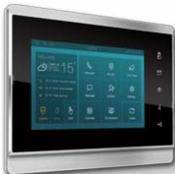
Monitor videocitofono, utilizzabile anche come pannello di controllo per il sistema Paser SmartHome.
